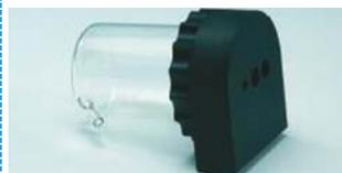
Сосуд с отверстиями для электрода рН-метра, мешалки, реактивов и дистиллята.
