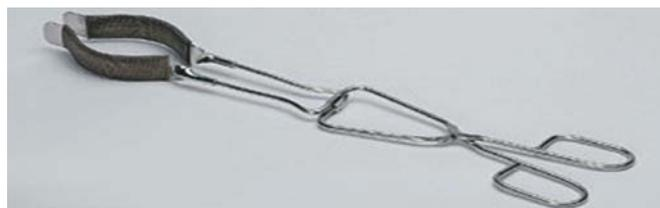
Оригинальный дизайн J.P.Selecta. Изготовлены из электрополированной нерж. стали AISI 304. Для стаканов объемом от 150 до 1500 мл и диаметром от 60 до 150 мм. Концы покрыты сеткой из стекловолокна. Кат. № 15.6016 общая длина 450 мм.
