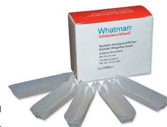
Исследуемый образец помещается в «лодочку» или на пергаментную бумагу, взвешивается и затем вместе с «лодочкой» или пергаментной бумагой помещается в колбу Кьельдаля или Сокслета. При этом полностью исключается потеря образца при взвешивании и при титровании не искажается содержание азота в образце. Рекомендуются «лодочки» и пергаментная бумага производства Whatman. «Лодочек» в упаковке – 100 шт., пергаментной бумаги – 500 шт.
