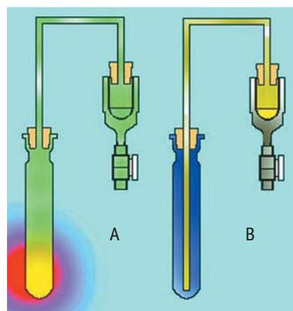
Гидролиз пробы: в положении «А» разрежение направлено на улавливание пара. Фильтрация и промывка: в позиции «В» разрежение способствует фильтрации.
