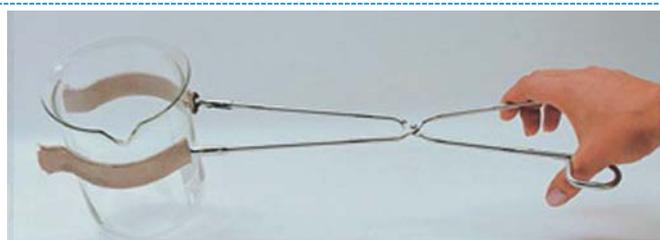
Из электрополированной нерж. стали AISI 304 для стаканов объемом 150 - 1500 мл диаметром от 60 до 150 мм. Концы покрыты стабилизированным стекловолокном. Кат. № 15.6014 общая длина 450 мм.
