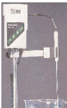
Цифровой термометр "Sensoterm". С термодатчиком Pt 100.
