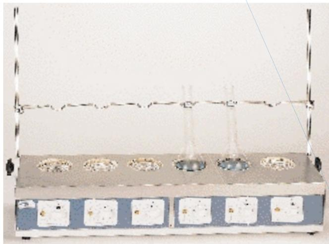
Батарея сеточных нагревателей с экстракционными аппаратами. Нагрев поверхности сеток до 450 °С
