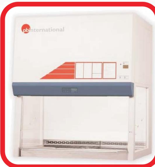
Микробиологический ламинарный бокс "Blu Space" II класса защиты с системой автоматической регулировки согласно Европейскому стандарту EN 12469. Гарантирует безопасность оператора, защиту продукта и окружающей среды во время работ с биологически активными или инфекционными веществами, которые могут сопровождаться образованием аэрозолей. Обычно применяется в микробиологии, вирусологии, гематологии,
