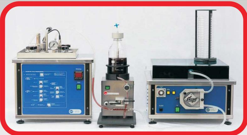
Эритроциты, добавляемые к агару при изготовлении кровяных сред для клинической микробиологии, не должны повреждаться высокой температурой во время приготовления среды. Использование установки "Blood-O-mat" производства International pbi позволяет получить партии кровяного агара, которые не портятся и долго хранятся. "Blood-O-Mat" — естественное дополнение средоварки "AgarSter" и установки для розлива агара "ADD-MINI SS".
