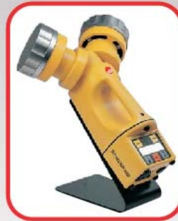
DUO SAS-SUPER 360-- пробоотборник, имеющий один корпус и две всасывающие головки, позволяющие производить посев на две разные среды одновременно. Позволяет отобрать 1000 л воздуха менее чем за 3 минуты. В этом заключаются революционные характеристики нового пробоотборника DUO SAS SUPER производства International PBI. К типичным примерам применения относятся: контроль чистоты воздуха в чистых комнатах, где
