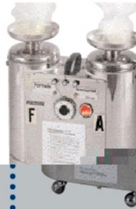
Установка "Formalintec" производства International Pbi - автоматическая система, переводящая формальдегид из жидкого состояния в газообразное путем нагревания, а затем нейтрализующая его аммиаком с образованием безвредного конечного продукта. Установка "Formalintec" подходит для дезинфекции помещений объемом от 100 до 500 куб. м, но возможно дезинфицировать объемы до 15000 куб. м.
