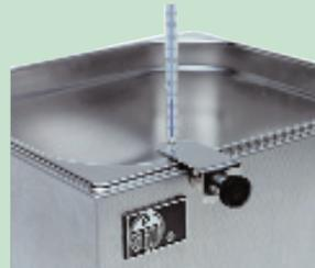
**Дежатель для термометра с винтом**
