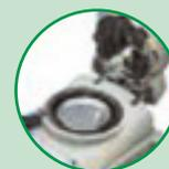
Большая круглая нагревательная камера с галогенной лампой для равномерного нагрева.
