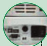
Интерфейсы USB и RS-232, разъем для блокировки и легко-доступный разъем для провода питания.
