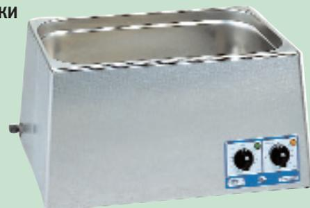
**ПРИМЕЧАНИЕ:** предметы, длина которых превышает размеры резервуара, например, трубки, пипетки и т.п. можно вставить в пробирку, заполненную жидкостью, и установить в очистителе вертикально. Эффект очистки при этом будет таким же.
