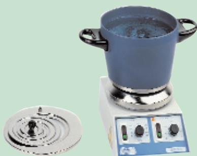
Подходит для мешалок «Аджиматик» и Рев-Е. Заполняется водой или маслом при температуре до 200 °С. Возможно перемешивание со скоростью от 150 до 1500 об/мин. Для роторных выпаривателей и т. п.
