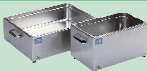
**Бани из нерж. стали,** с термоизоляцией. Идеальны для низких температур. Подходят для охлаждающих блоков Селекта. Внешне похожи на остальные бани, но имеют дополнительную внутреннюю термоизоляцию из вспененного материала, препятствующую конденсации и потере тепла, рабочая температура от -40°C до +90°C.
