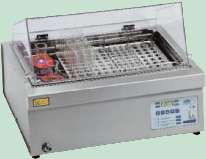
Перемешивание внутренним циркуляционным насосом.
