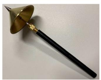
Конус с ручкой для определения пенетрации (соответствует требованиям ASTM D 217 и D 937).
