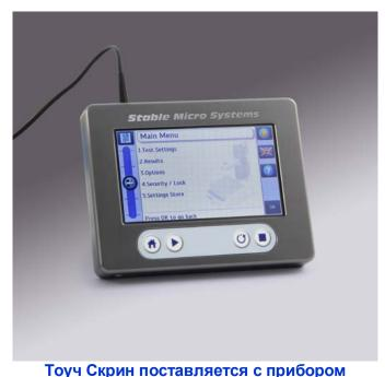
Диапазон скоростей: от 0,01 мм\сек до 20 мм\сек. Разрешение в диапазоне - 0,001 мм. Частота получаемых данных — 2000 точек в секунду.
