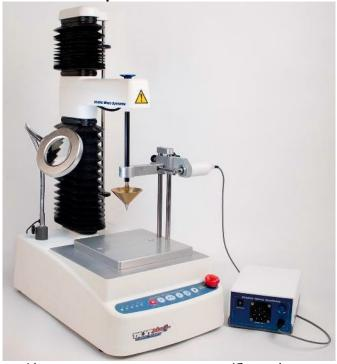
Имеет одну направляющую с/без гофры (рабочая высота — 485 мм). Расширенные возможности по размещению дополнительных аксессуаров для удобства исследований. Сила воздействия на образец (тензодатчик) — 50 кг.
