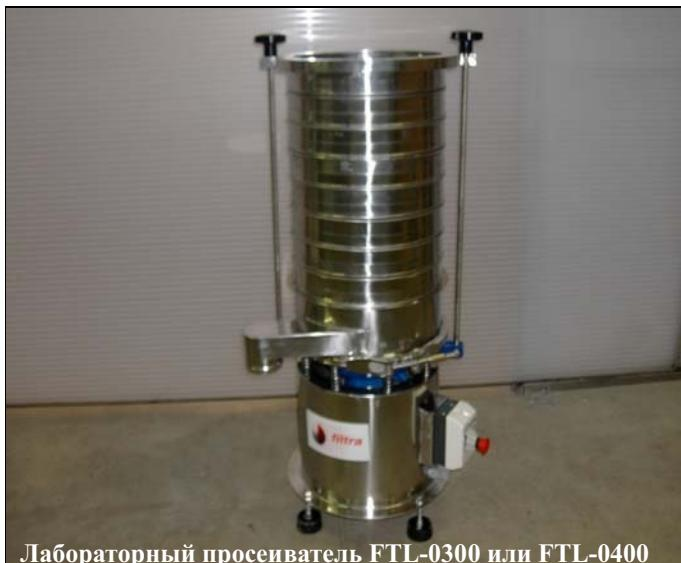
Лабораторный просеиватель FTL-0300 или FTL-0400
