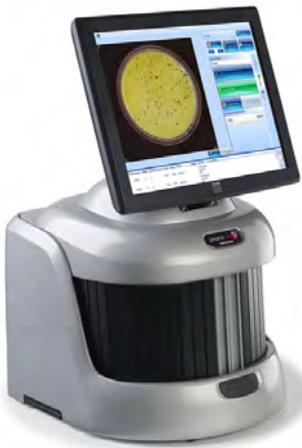
Программа в комплекте обладает возможностями подсчета числа колоний бактерий, измерения диаметров зон вокруг дисков с антибиотиками и зон иммуноглобулинов, гемагглютининов в агаре.
